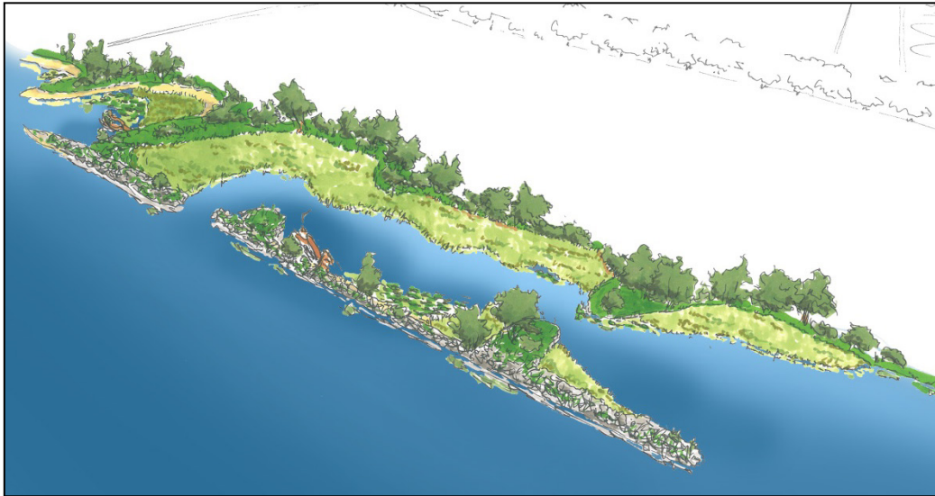
Abbildung 64: Planungsskizze 1 aus der „Machbarkeitsstudie Weserschleifen“ zum Umbau von Buhnen in unterbrochene Parallelwerke. Diese ermöglichen eine naturnahe Entwicklung der Weserufer mit einem vielseitigen Habitatangebot für Wasser-, Wat- und Feuchtgebietsvogelarten (Quelle: UIH Ingenieur- und Planungsbüro 2014).
